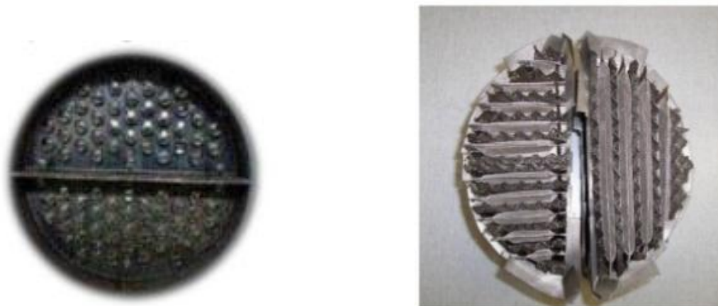
Slika 2.19. Unutrašnjost kolone s razdjelnom stijenkom:
