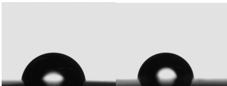
Slika 4.6. CuSn 6 nezaštićeno 82,54 \pm 1,47^\circ
