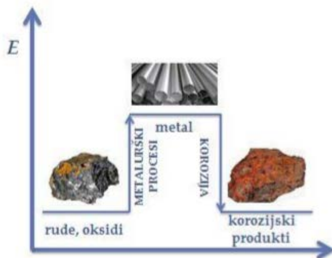
Slika 2.1. Energetske promjene pri dobivanju i koroziji metala [3]
