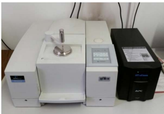
Slika 3.7. FTIR spektrometar, Perkin Elmer Spectrum One Spectrometer s ATR komorom
