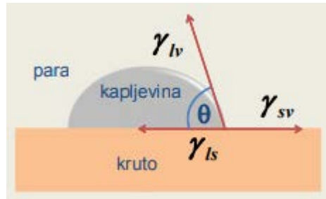
Slika 3.13. Određivanje kontaktnog kuta [32]
