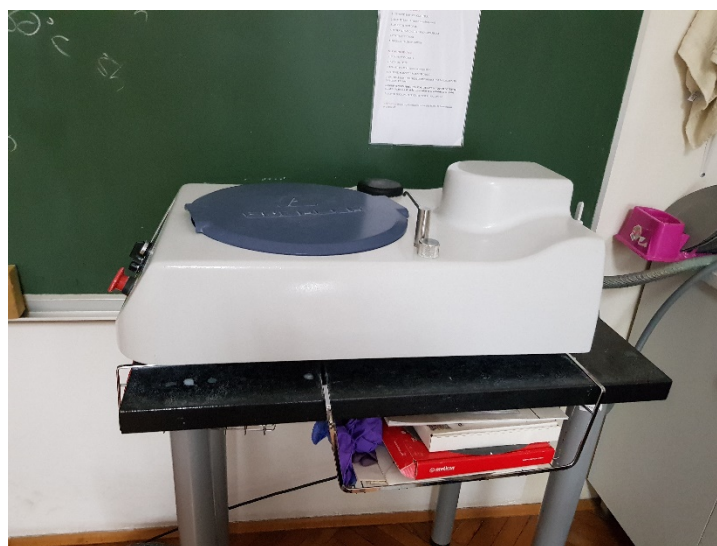
Slika 3.3. Uređaj za poliranje uzorka
