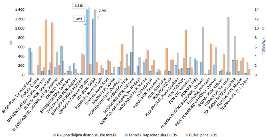
**Slika 11.** Usporedba duljine distribucijskih sustava, ukupnog tehničkog kapaciteta ulaza u distribucijske sustave i gubitaka plina po operatorima distribucijskog sustava u Republici Hrvatskoj u 2018. godini [2]
