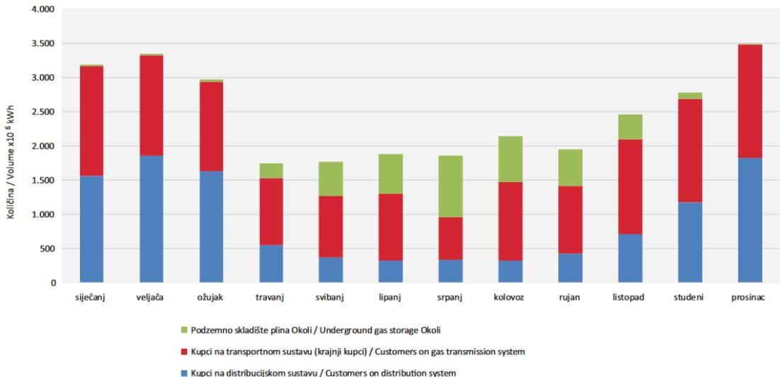
**Slika 1.** Struktura transportiranih količina prirodnog plina prema izlaznim mjerno-redukijskim stanicama (IMRS) tijekom 2018. godine [1]
