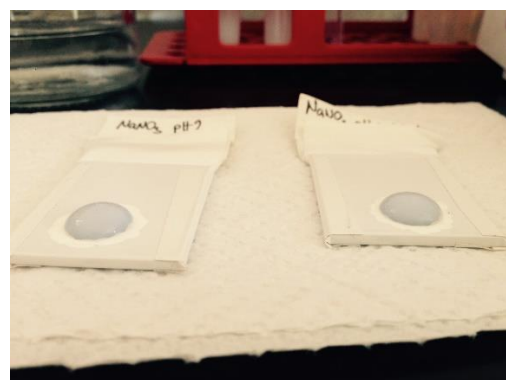
Slika 6. Elektrode s kapanim premazom na površini.
