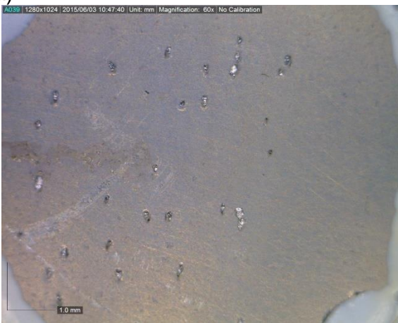
Slika 17. Jamičasta korozija na premazu ADNO 3 H 2 O pri a) sobnom i b) UV osvjetljenju.
