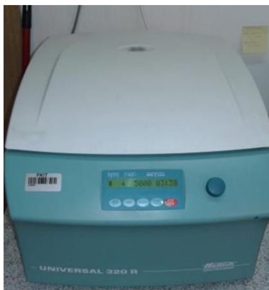
Slika 9. Centrifuga Hettich Universal 320R .
