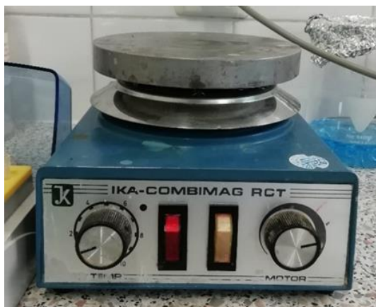
Slika 15. Magnetska miješalica s grijačem IKA – COMBIMAG RCT .
