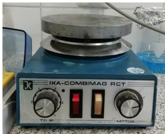
Slika 15. Magnetska miješalica s grijačem IKA – COMBIMAG RCT .
