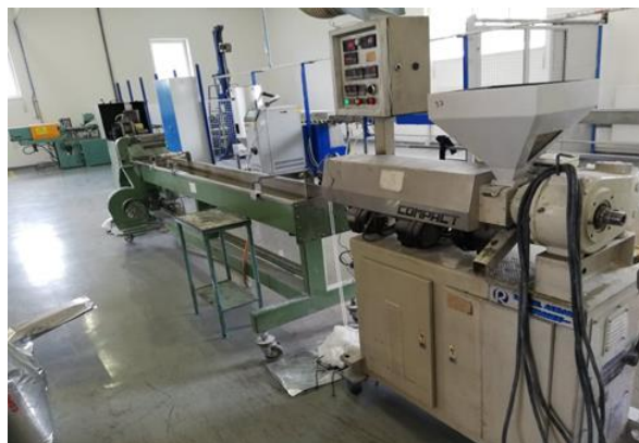
Slika 18. Dvopužni ekstruder Haake Record 90
