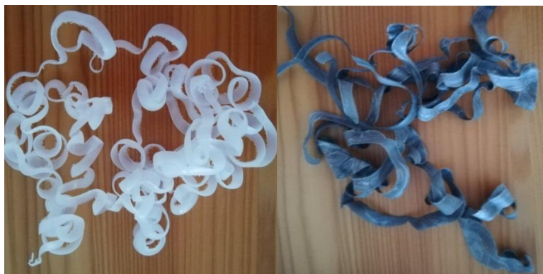
Slika 24. Trake pripravljene za određivanje sadržaja gela za a) izolaciju i b) plašt
