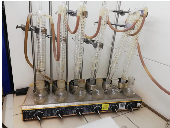
Slika 25. Aparatura za određivanje sadržaja gela
