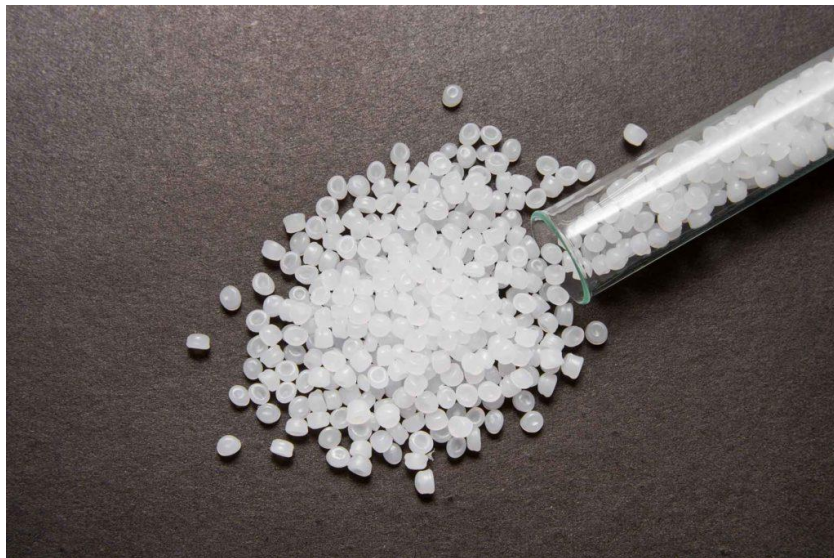
Slika 6. Prikaz granula polietilena [16]
