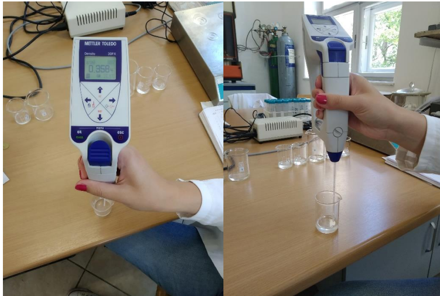
Slika 17. Uređaj za mjerenje gustoće Mettler Toreda Densito 30PX .
