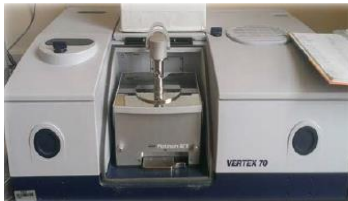
Slika 16. Fotografija FTIR spektrofotometra Vertex 70 s platinastim detektorom (Bruker).
