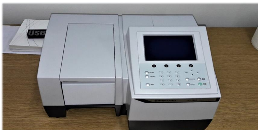
Slika 25. Fotografija spektrofotometra UV-1280 (Shimadzu, Kyoto, Japan)
