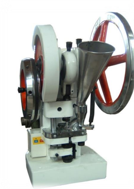
Slika 19. Fotografija uređaja za tabletiranje TDP-5T (Zhejiang Wisely Machinery Co., NR Kina)
