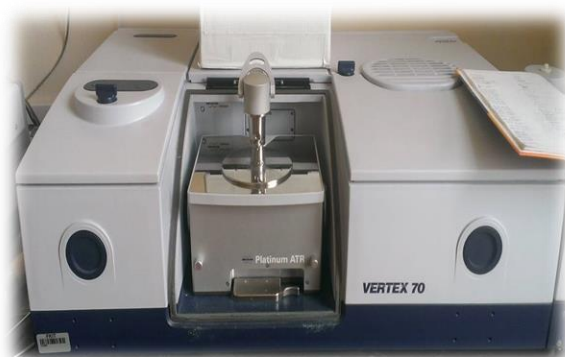
Slika 21. Fotografija FTIR spektrofotometra Vertex 70 s platinastim detektorom (Bruker, Billerica, SAD)
