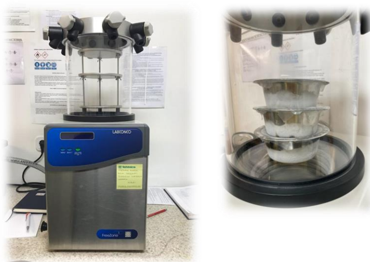
Slika 17. a) Fotografija liofilizatora FreeZone 1 (Labconco Co., Kansas City, SAD) b) Fotografija postavljenih uzoraka u liofilizatoru
