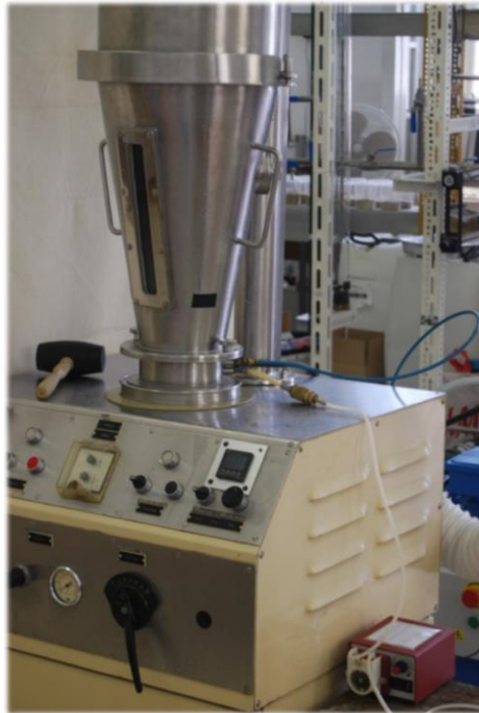
Slika 18. Fotografija granulatora s fluidiziranim slojem Uni-Glatt (Glatt GmbH, Binzen, SR Njemačka)
