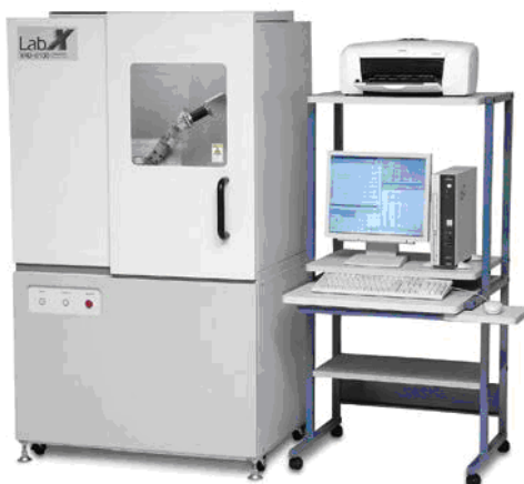
Slika 20. Fotografija uređaja za rendgensku difrakciju praha XRD-6300 (Shimadzu, Kyoto, Japan)
