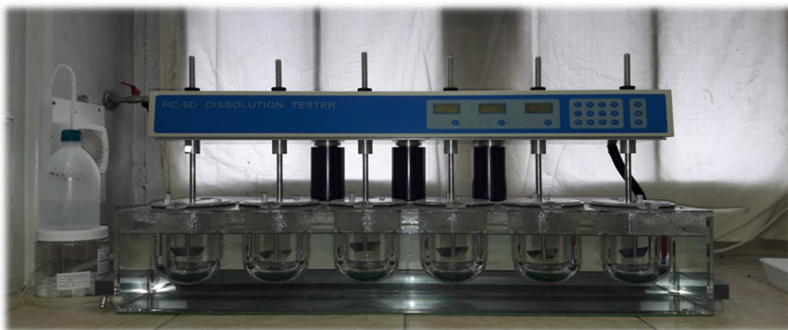
Slika 26. Fotografija uređaja za ispitivanje oslobađanja djelatne tvari RC-6D (Zhengzhou Nanbei Instrument, Henan, NR Kina)
