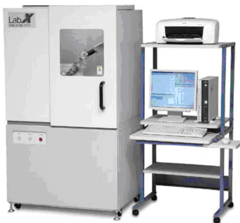
Slika 20. Fotografija uređaja za rendgensku difrakciju praha XRD-6300 (Shimadzu, Kyoto, Japan)
