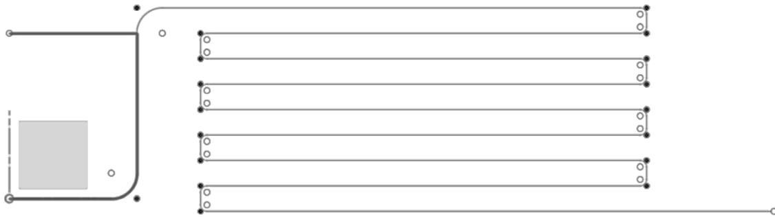
Slika 21. Prikaz reakcijskog volumena mikrokanala (svjetlo siva boja)
