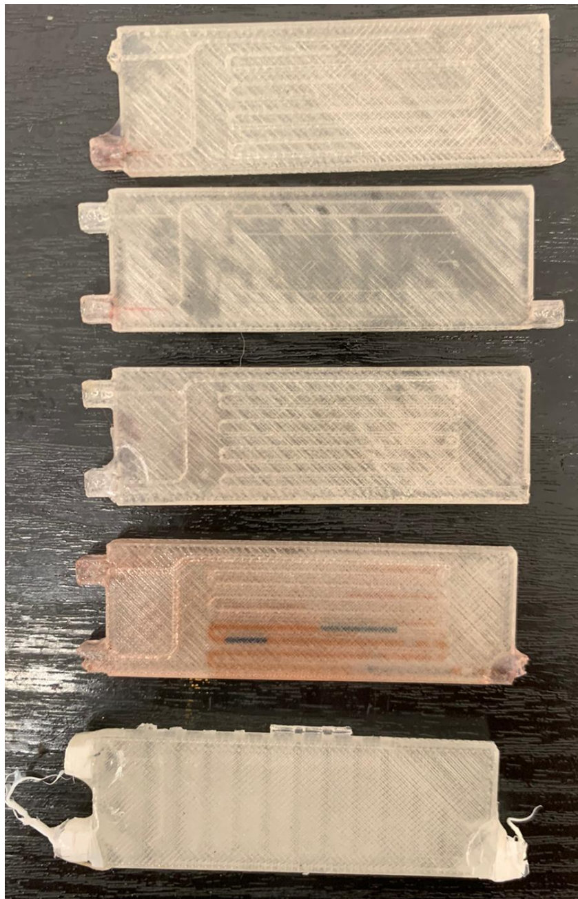
Slika 35. Mikroreaktori koji nisu za daljnju uporabu i mikroreaktor s modificiranim načinom spajanja
