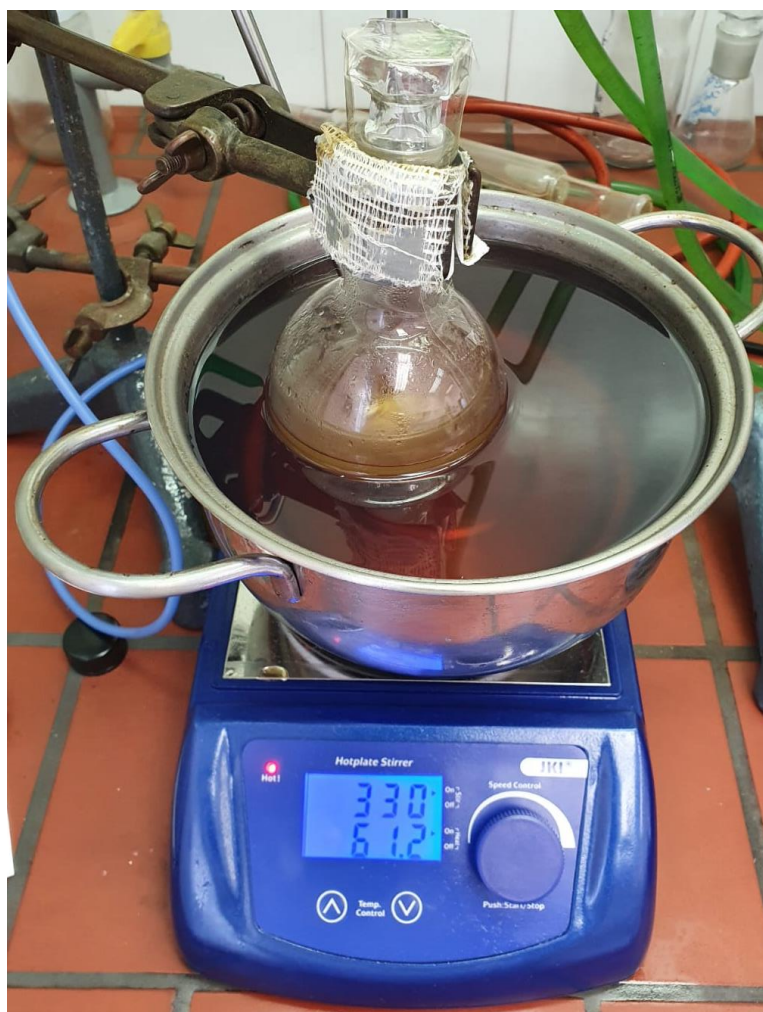
Slika 23. Šaržna reakcija biodizela
