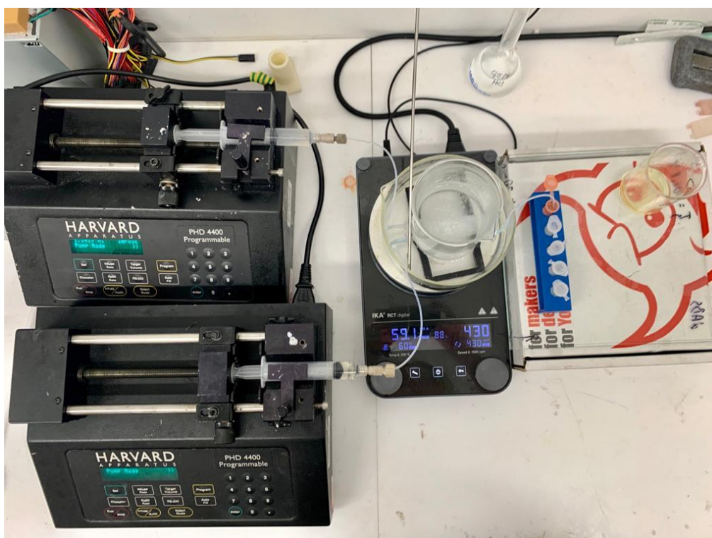
Slika 39. Provođenje sinteze biodizela u mikroreaktoru
