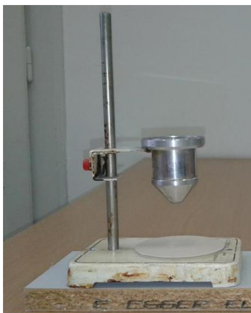
Slika 15. Lijevak za određivanje kuta mirovanja, Zavod za mehaničko i toplinsko procesno inženjerstvo, FKIT
