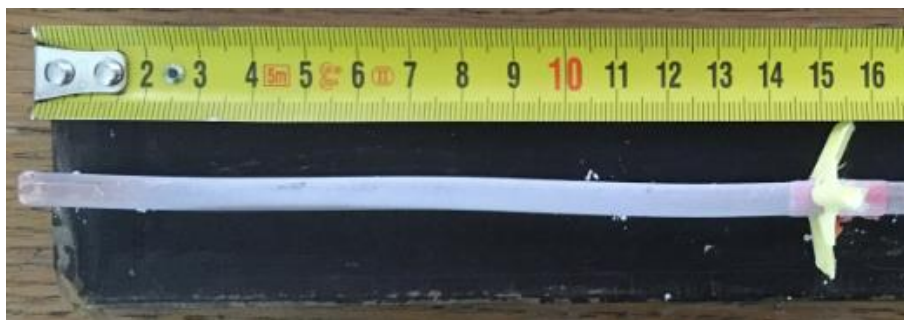
Slika 33. Prikupljanje čestica talka pri U = 10 \text{ kV} , \dot{m} = 0,319 \text{ g/s}
