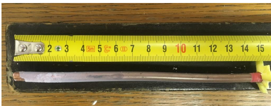
Slika 35. Prikupljanje čestica Aerosila pri U = 10 \text{ kV} , \dot{m} = 0,319 \text{ g/s}
