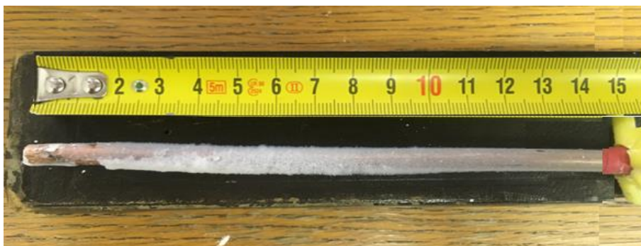
Slika 36. Prikupljanje čestica Aerosila pri U = 10 kV, \dot{m} = 0,385 g/s
