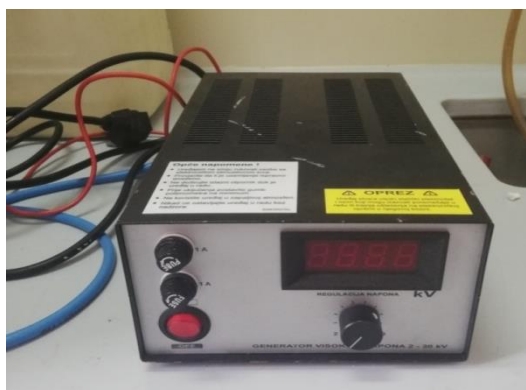
Slika 20. Generator visokog napona, 2 kV-30 kV
