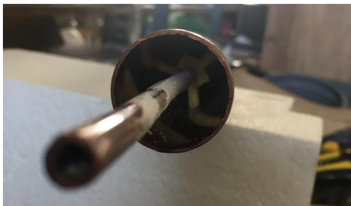
Slika 17. Izvedba elektrofiltera cijev u cijevi
