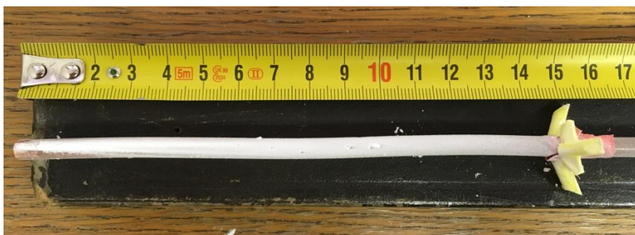
Slika 34. Prikupljanje čestica talka pri U = 10 \text{ kV} , \dot{m} = 0,385 \text{ g/s}
