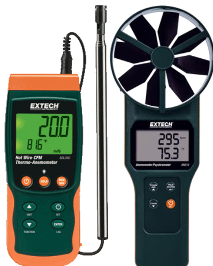
Slika 9. Mjerač brzine i temperature zraka s termalnim anemometrom (lijevo) i instrument za mjerenje brzine, protoka, temperature i vlage zraka s ugrađenom vjetrenjačom (desno)
