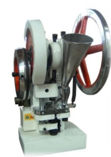
Slika 7. Uređaj za tabletiranje TDP-5T (Zhejiang Wisely Machinery Co., NR Kina)
