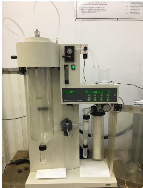
Slika 5. Laboratorijski sušionik s raspršivanjem (BÜCHI Mini Spray-Dryer B-290)
