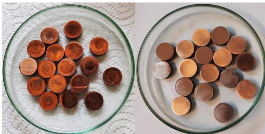
Slika 8. Prikaz bakrenih elektroda prije i poslije poliranja
