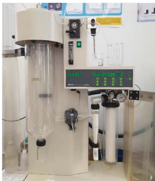
Slika 20. Sušionik s raspršivanjem Mini Spray Dryer B-290
