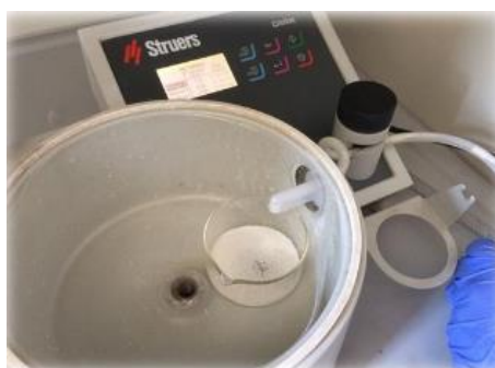
Slika 12. Uređaj za vakuumsku impregnaciju Cito Vac ( Struers, Njemačka ) 28
