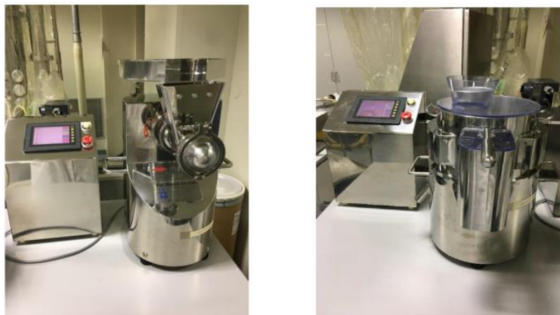
Slika 10. Ekstruder (lijevo) i sferonizator (desno) 28
