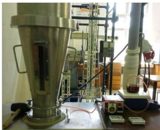
Slika 13. UniGlatt uređaj za oblaganje u fluidiziranom sloju ( Glatt GmbH, Njemačka ) 28
