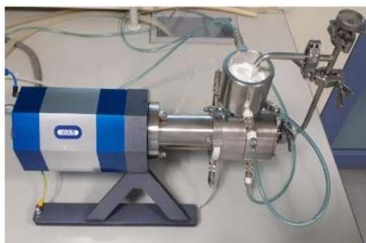
Slika 11. Mlin Dyno-mill Research Lab ( WAB, Švicarska ) 28
