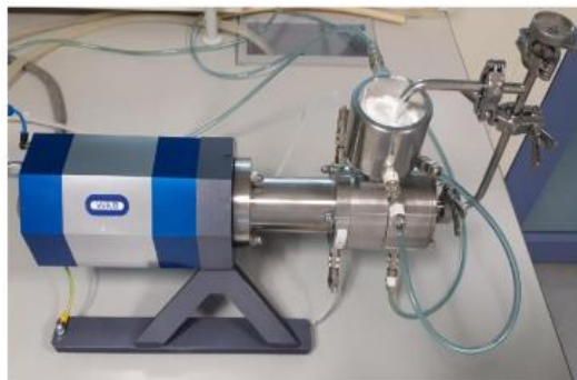
Slika 11. Mlin Dyno-mill Research Lab ( WAB, Švicarska ) 28
