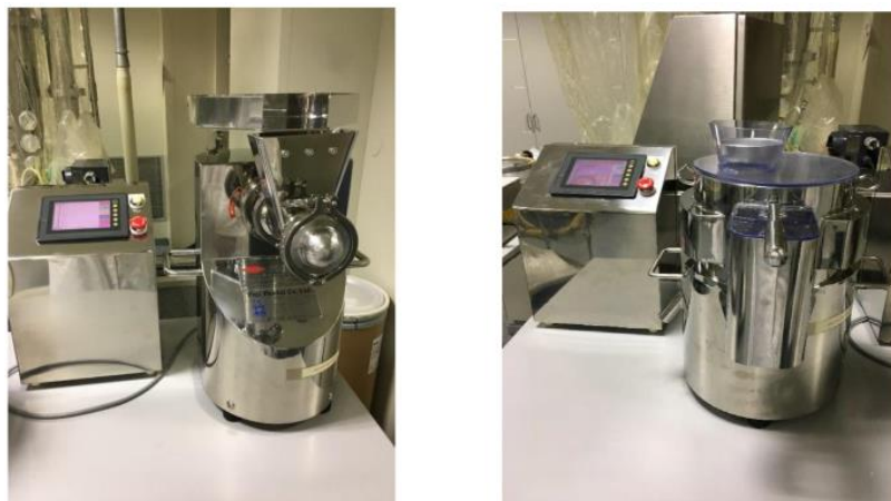
Slika 10. Ekstruder (lijevo) i sferonizator (desno) 28
