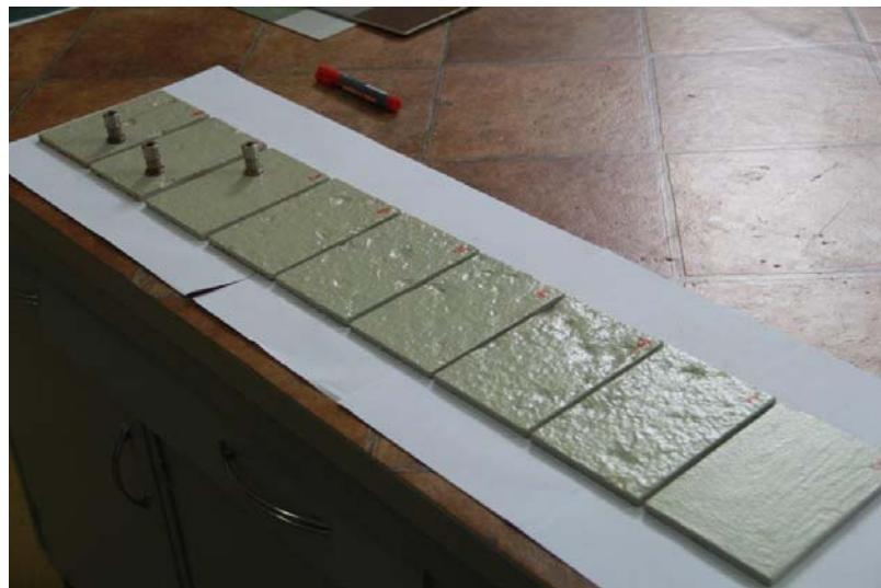
**Slika 6.** Prikaz ploča za mjerenje prionjivosti.
