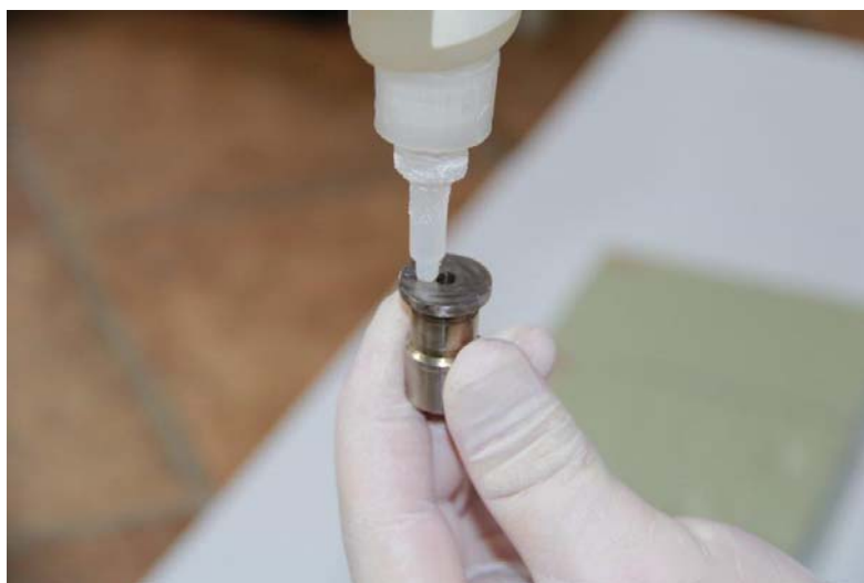
Slika 7. Nanošenje ljepila na cilindar.
