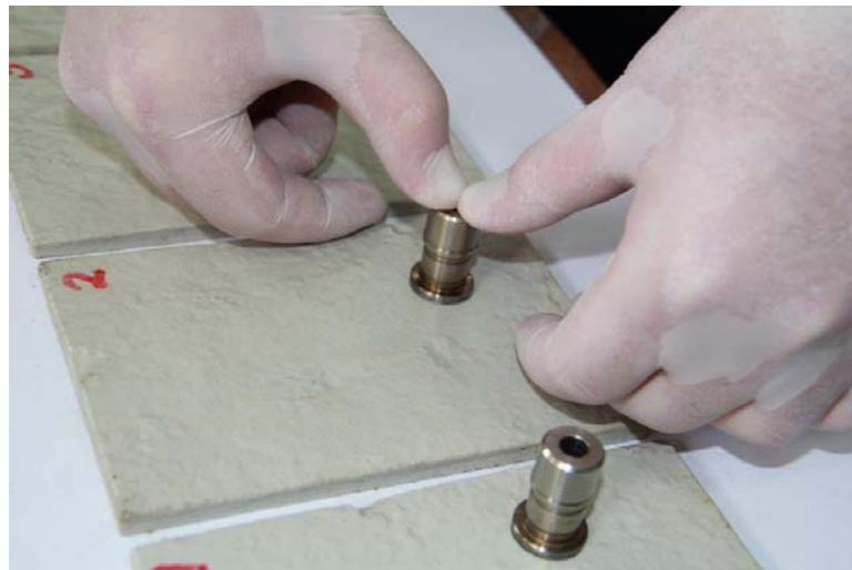
**Slika 8.** Naljepljivanje cilindara na ploče.
