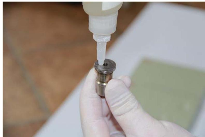
**Slika 7.** Nanošenje ljepila na cilindar.
