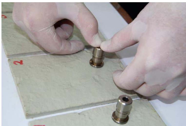
Slika 8. Naljepljivanje cilindra na ploče.
