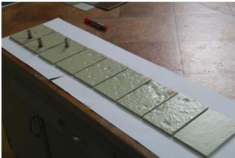
Slika 6. Prikaz ploča za mjerenje prionjivosti.
