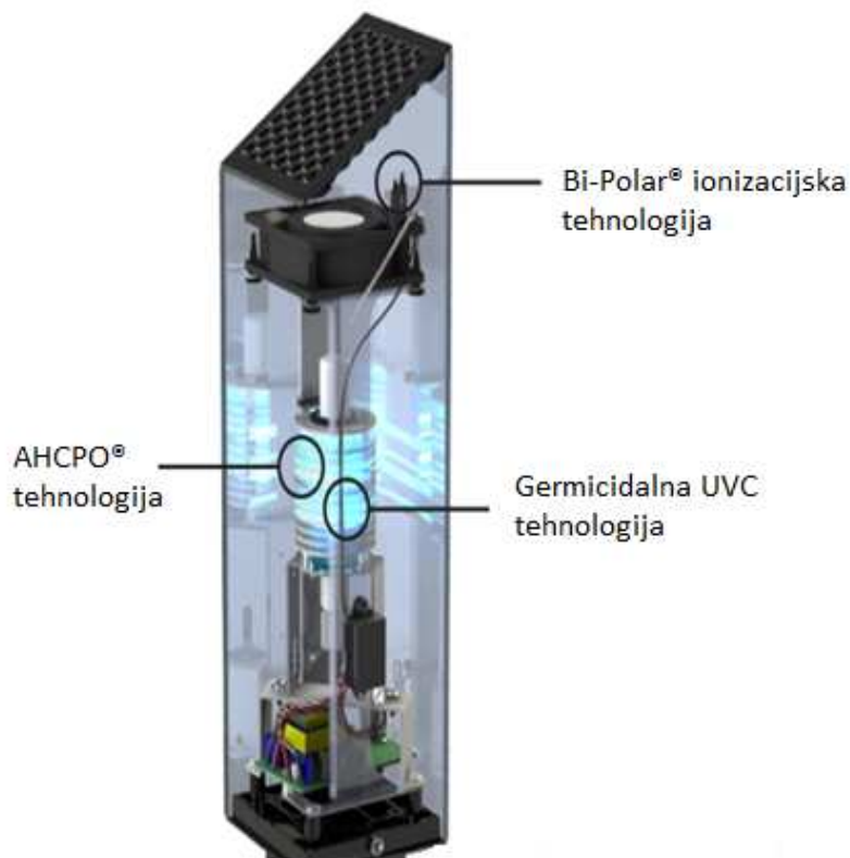
Slika 13. Unutrašnjost pročišćivača zraka 3000G3 Large Room Air Purifier [prilagođeno prema referenci [32]].
