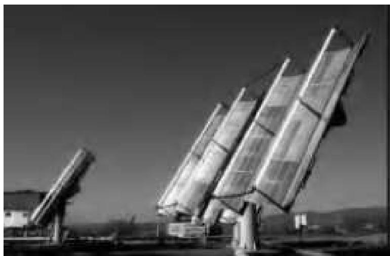
Slika 17. *Solarni parabolični kolektor (PTC)* [6].
