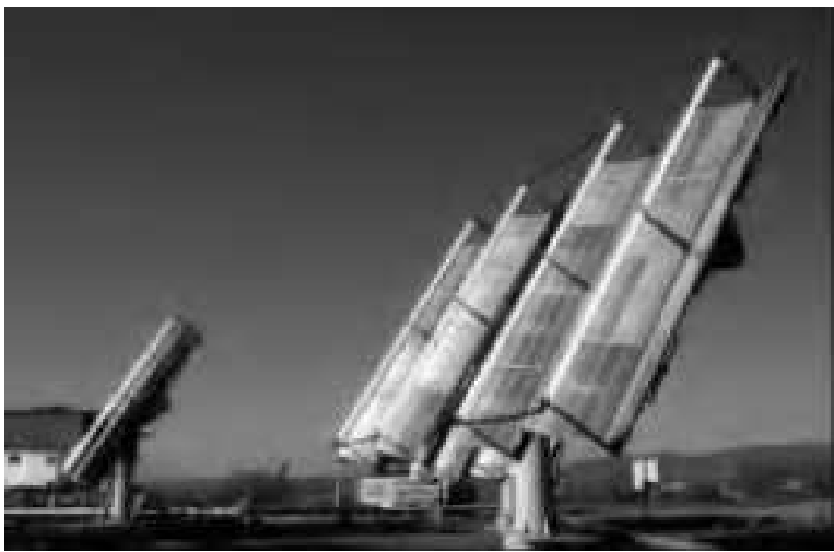
Slika 17. Solarni parabolični kolektor (PTC) [6].
