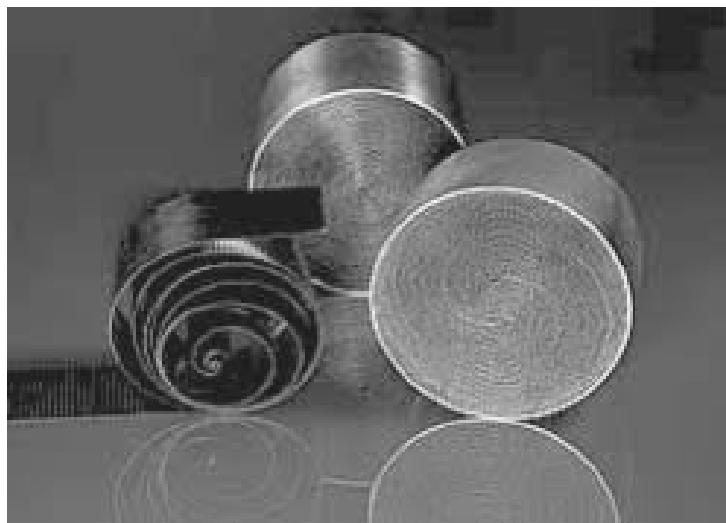
**Slika 12- Priprava metalnih monolita [28]**
