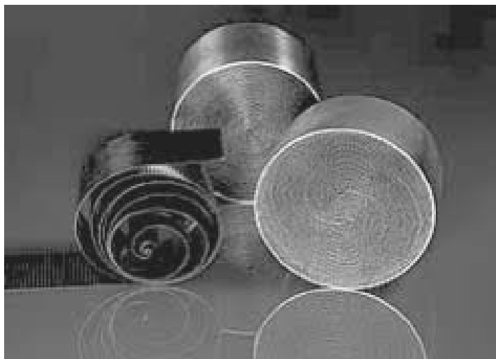
Slika 12- Priprava metalnih monolita [28]
