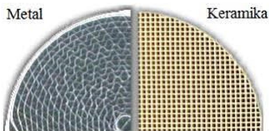
**Slika 6- Prikaz metalnog i keramičkog monolitnog katalizatora [23]**
