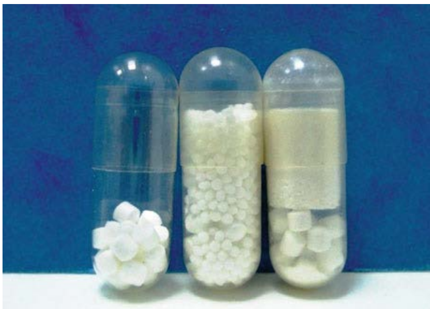
Slika 2.9. Primjer tvrde kapsule punjene s a) minitabledama, b) minitabledama i peletama i c) minitabledama i praškom
