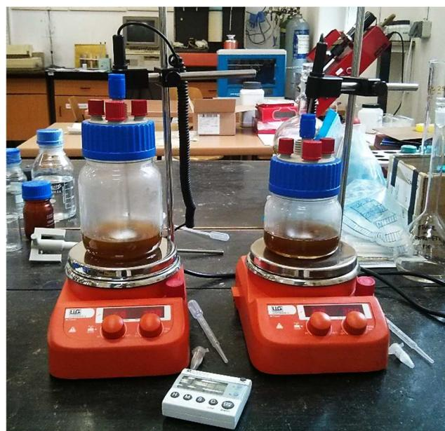
Slika 21. Postupak adsorpcije s dva adsorbensa
