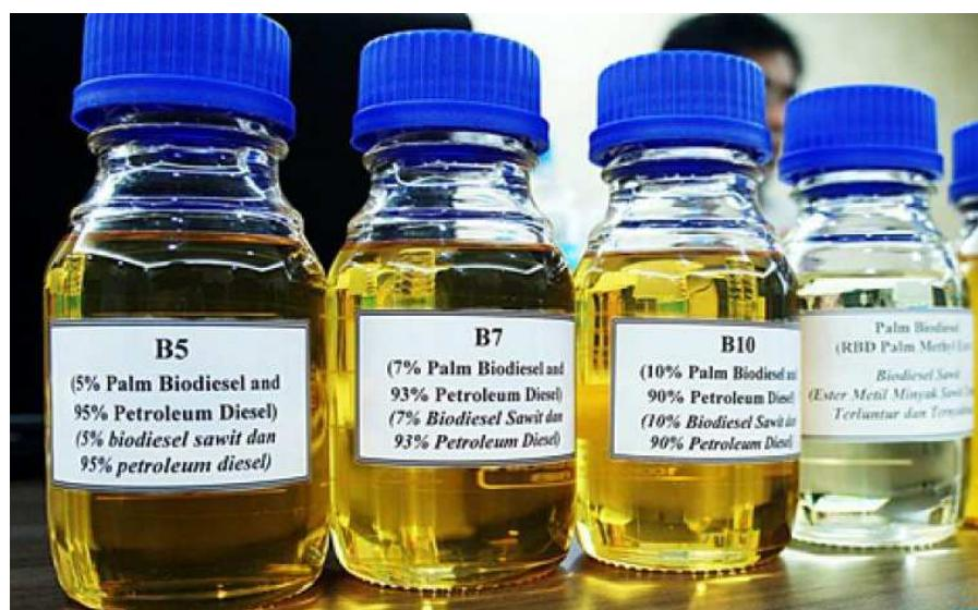
Slika 4. Mješavine biodizela i fosilnog dizela i čisti biodizel <sup>[13]</sup>
