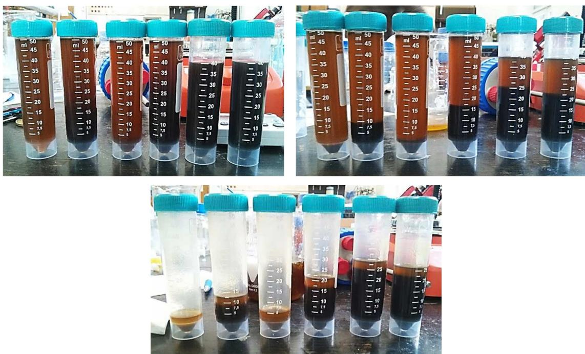
Slika 19. Usporedba kiveta a) prije centrifugiranja, b) nakon centrifugiranja i c) nakon dekaniranja
