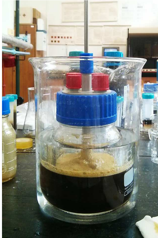
Slika 16. Zagrijavanje otpadne životinjske masti pomoću vodene kupelji
