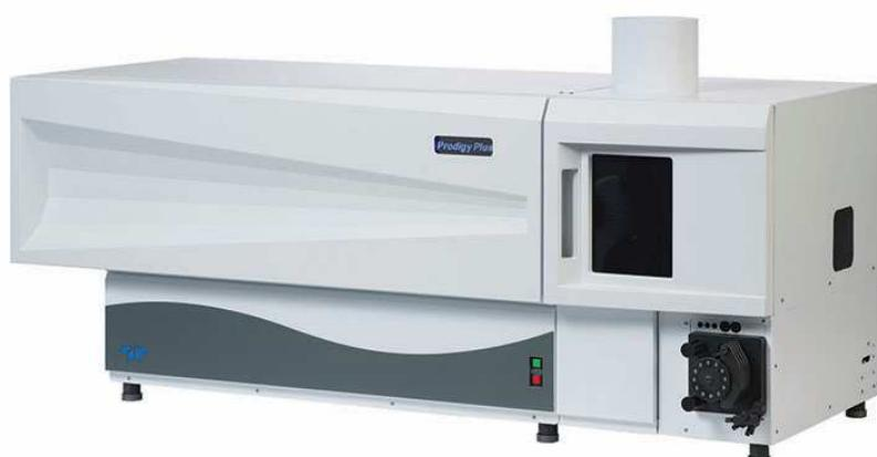
Slika 24. ICP-OES uređaj [24]
