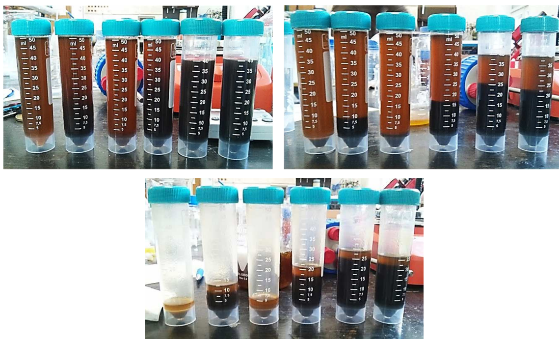
Slika 19. Usporedba kiveta a) prije centrifugiranja, b) nakon centrifugiranja i c) nakon dekantiranja
