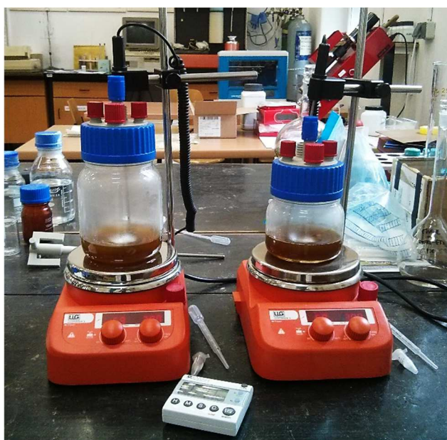
Slika 21. Postupak adsorpcije s dva adsorbensa
