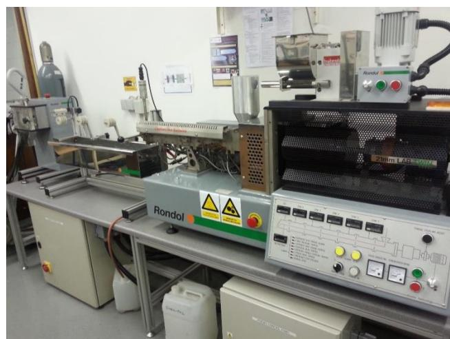
Slika 19. Rondol 21mm LAB TWIN ekstruder
