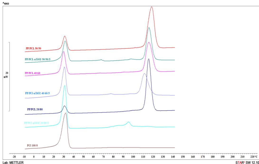
Slika 27. DSC krivulje hlađenja PP i PCL-a, te mješavine PP/PCL bez dodatka i sa dodatkom nTiO<sub>2</sub>
