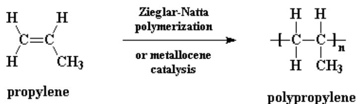
Slika 5. Shematski prikaz polimerizacije propilena<sup>7</sup>
