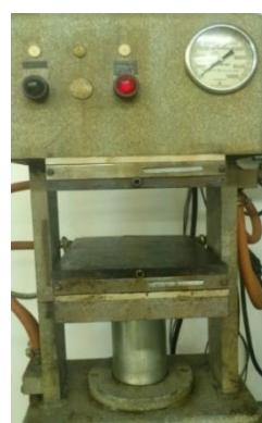
Slika 20. Hidraulička preša Dake Model 44-226
