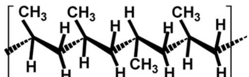
Slika 4. Ataktni poliproplien<sup>6</sup>
