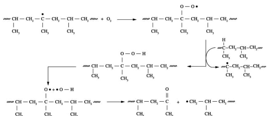
Slika 18. Mehanizam razgradnje polipropilena<sup>21</sup>
