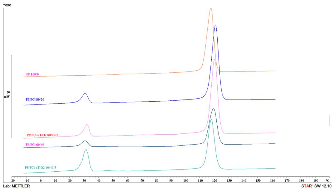
Slika 26. DSC krivulje hlađenja PP i PCL-a, te mješavine PP/PCL i bez dodatka i sa dodatkom nTiO<sub>2</sub>
