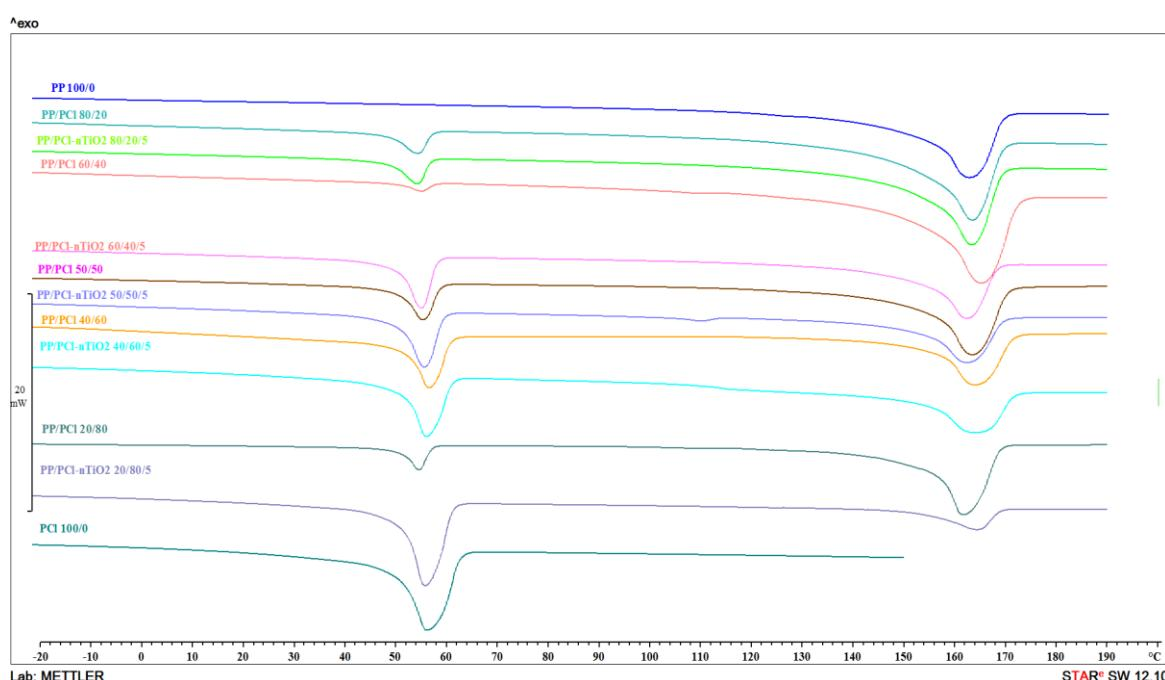
Slika 25. DSC krivulje zagrijvanja PP i PCL-a, te mješavine PP/PCL bez dodatka i sa dodatkom nTiO<sub>2</sub>
