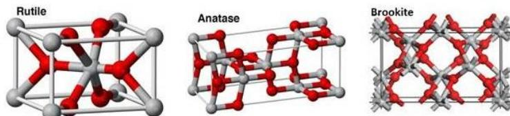
Slika 12. Kristalne strukture TiO<sub>2</sub><sup>14</sup>
