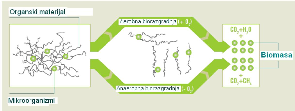
Slika 2. Proces anaerobne i aerobne biorazgradnje<sup>4</sup>
