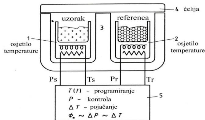
Slika 14. Kompenzacijski diferencijalni pretražni kalorimetar
