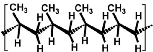
Slika 3. Izotaktni polipropilen<sup>6</sup>
