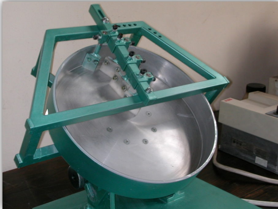
Slika 2.6. Fotografija disk granulatora u laboratorijskom mjerilu (Fakultet kemijskog inženjerstva i tehnologije, Zavod za mehaničko i toplinsko procesno inženjerstvo, Zagreb, Republika Hrvatska).
