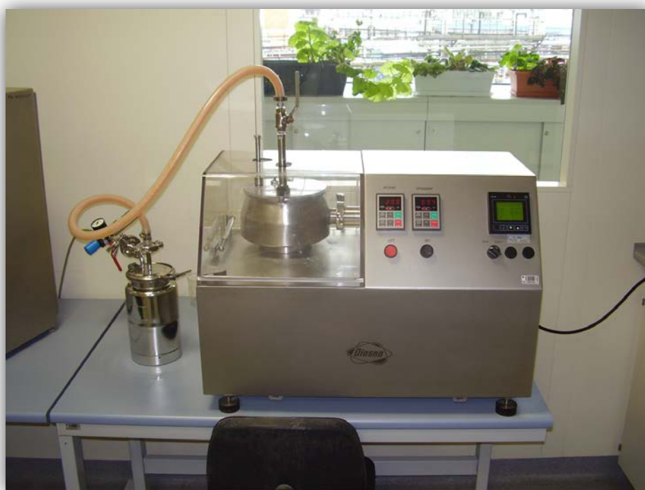
Slika 2.5. Fotografija smičnog granulatora (Farmaceutska tehnologija, PLIVA Hrvatska d.o.o.).
