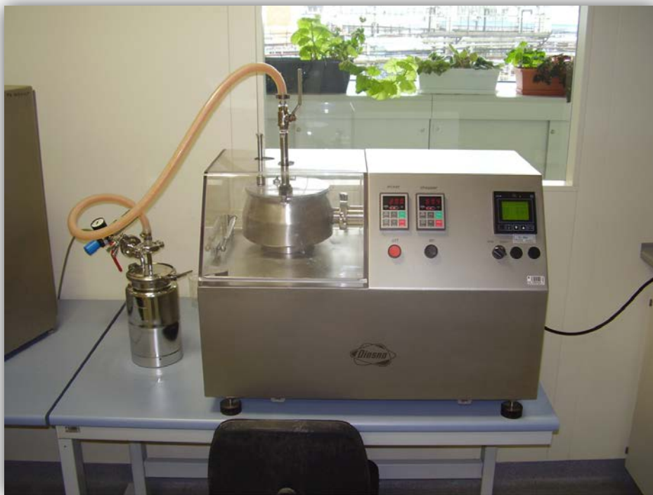
Slika 2.5. Fotografija smičnog granulatora (Farmaceutska tehnologija, PLIVA Hrvatska d.o.o.).
