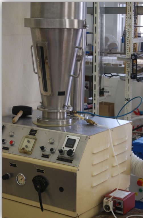
Slika 2.7. Fotografija granulatora s fluidiziranim slojem Uni-Glatt (Glatt GmbH, Binzen, SR Njemačka).
