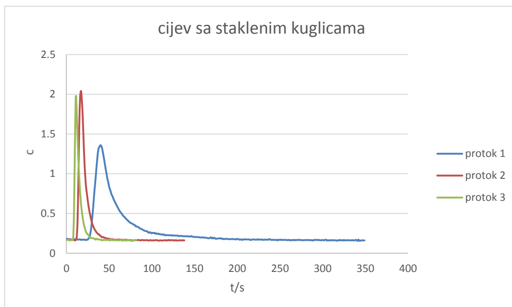
Slika 3.4. Promjena protoka u cijevi sa staklenim kuglicama pri volumenu trasera 0,5 mL
