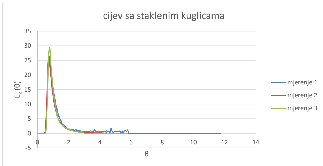
Slika 4.3. Provedba eksperimenta tri puta pri istim uvjetima volumena trasera 0,5 mL i protoka 3 u cijevi sa staklenim kuglicama
