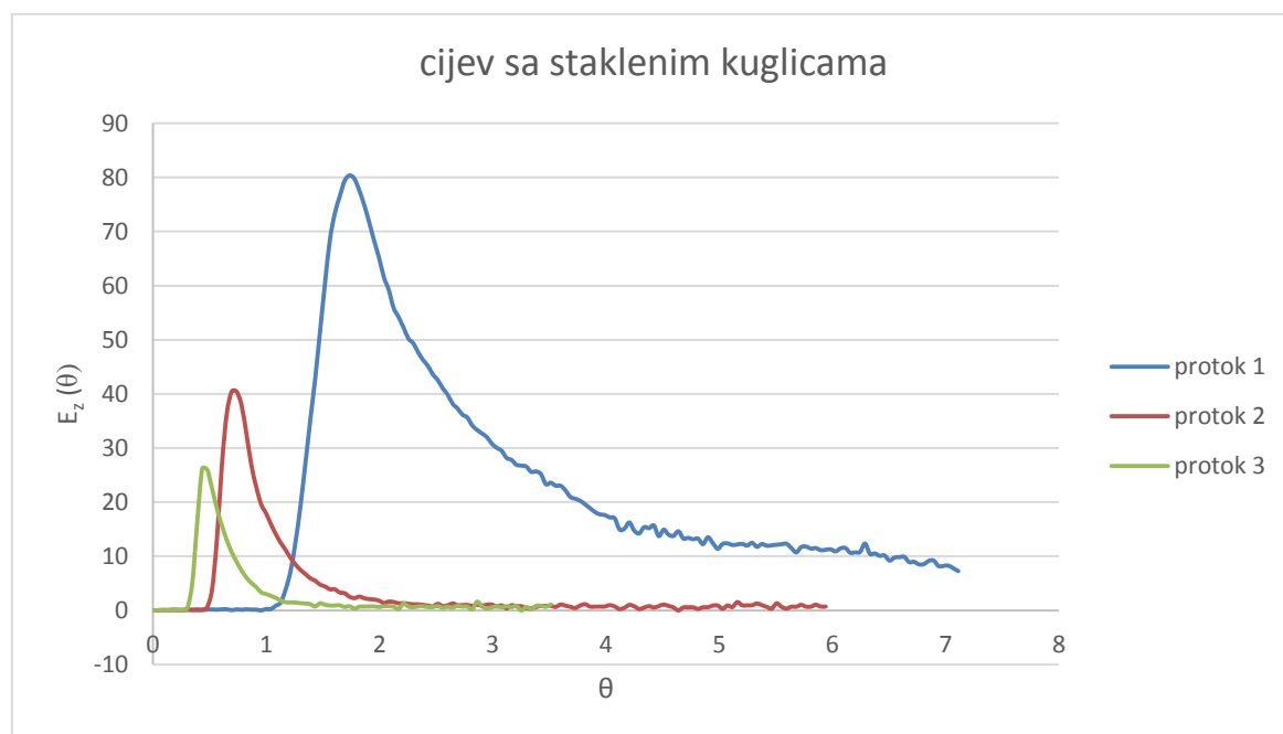
Slika 4.1. Promjena protoka u cijevi sa staklenim kuglicama pri volumenu trasera 0,5 mL
