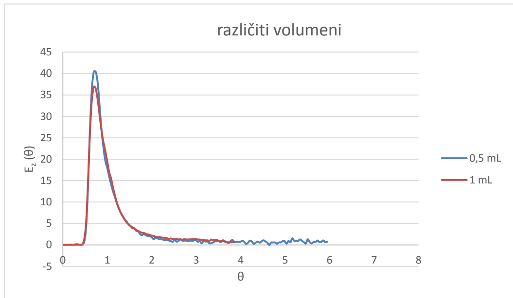
Slika 4.6. Promjena volumena traseru u cijevi sa staklenim kuglicama pri protoku 2
