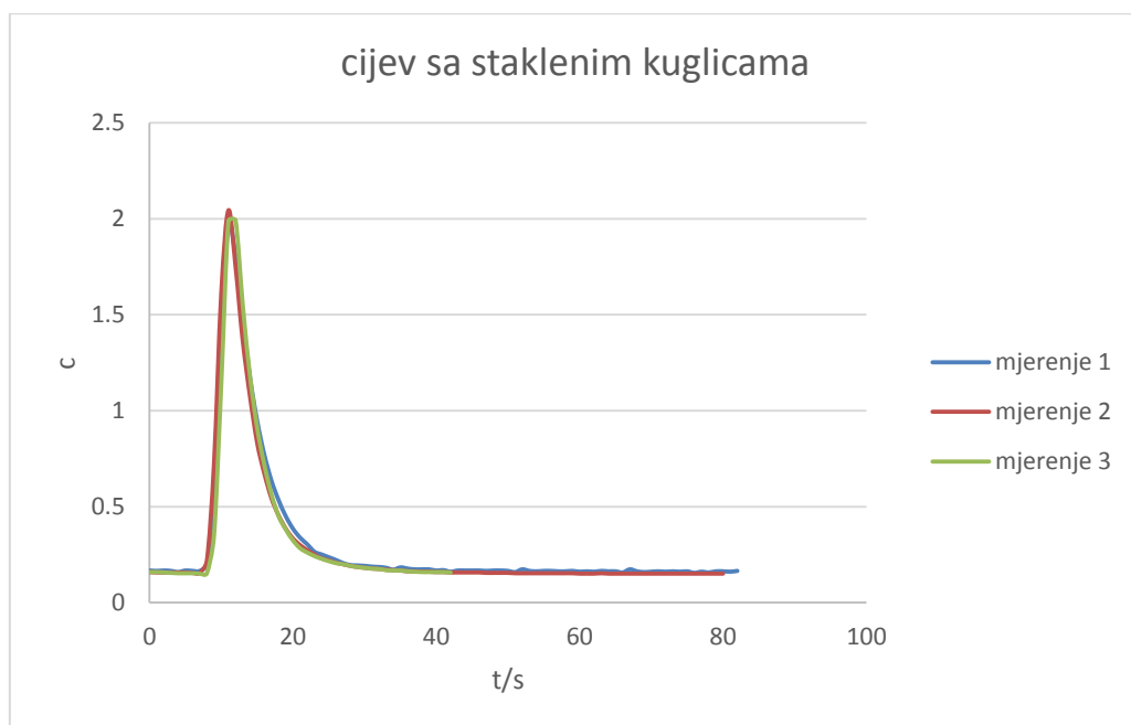
Slika 3.6. Provedba eksperimenta tri puta pri istim uvjetima volumena trasera 0, 5 mL i protoka 3 u cijevi sa staklenim kuglicama
