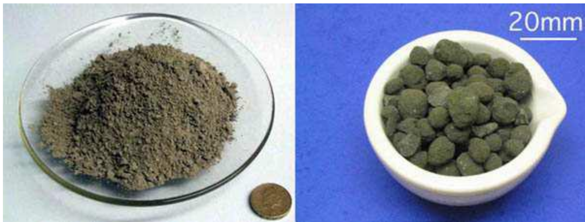
Slika 2. Lijevo- cement nakon mljevenja, desno- granule cementa od 20 mm prije mljevenja [3]
