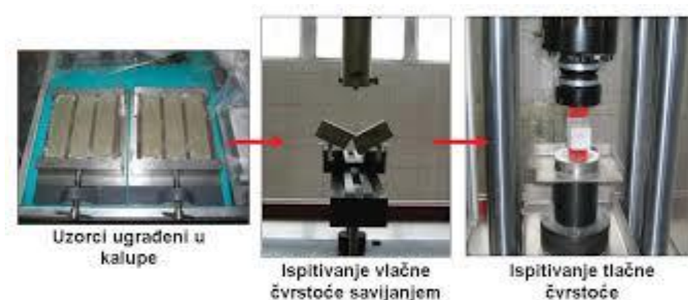
Slika 3. Ispitivanje čvrstoće na savijanje i čvrstoće na tlak na normiranim uzorcima
