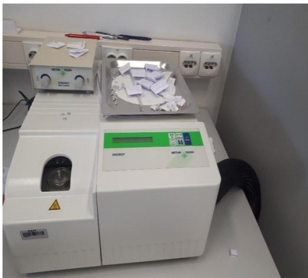
Slika 17. Diferencijalni pretražni kalorimetar Mettler toledo DSC 823e
