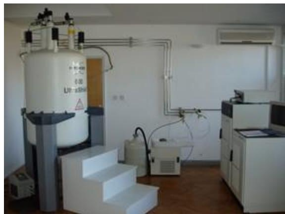
**Slika 15.** NMR spektrometar Bruker Avance 600
