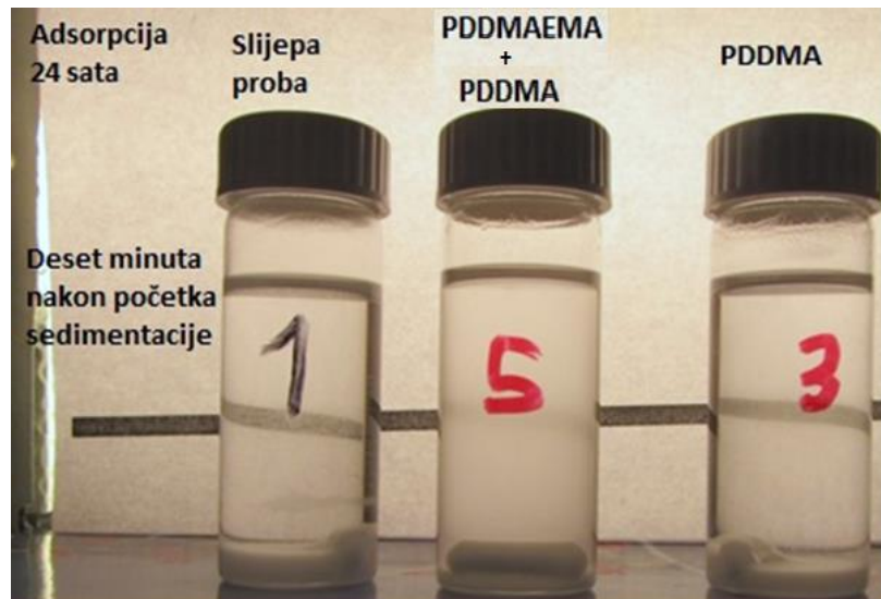
Slika 21. Stabilnost suspenzija deset minuta nakon početka sedimentacije
