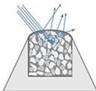
**Slika 9.** Nosač za DRIFT eksperiment<sup>12</sup>
