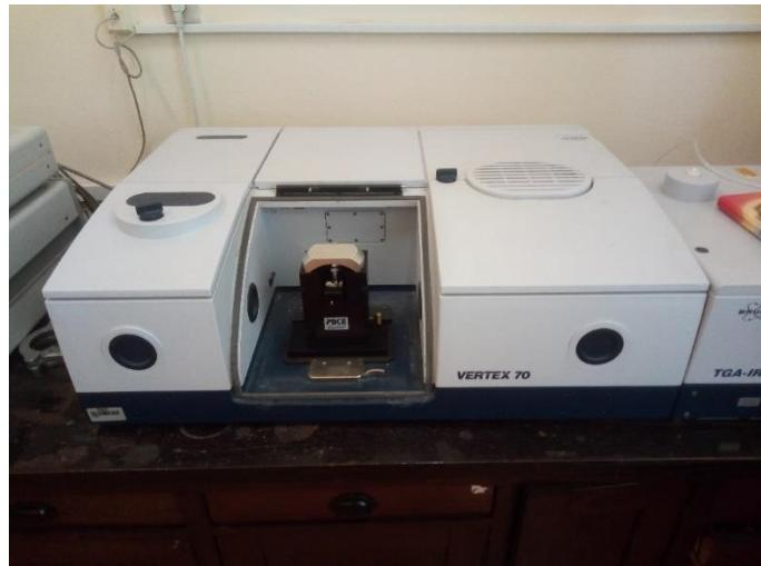
**Slika 17.** Spektrofotometar Bruker VERTEX 70
