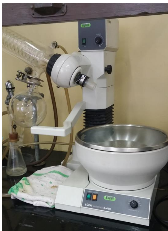
Slika 14. Rotavapor Büchi Waterbath B – 480
