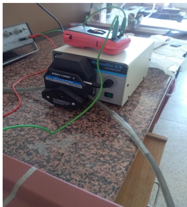
Slika 28. Pumpa i amperometar
