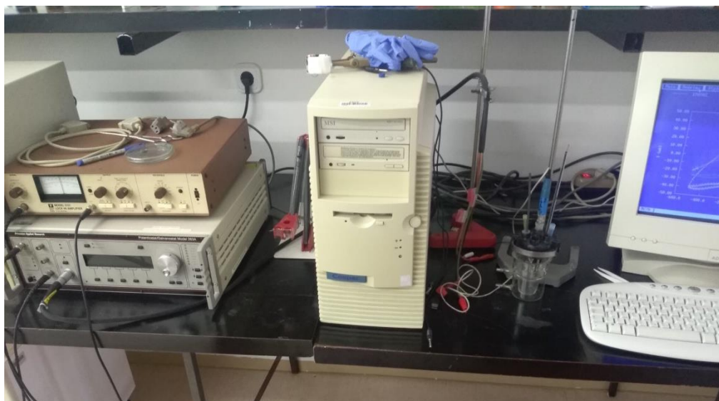
Slika 30. Potenciostat (EG&G Princeton Applied Research, model 263A), osobno računalo i ćelija
