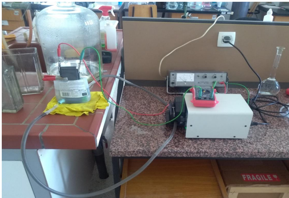
Slika 26 . Aparatura za provođenje kapacitivne deionizacije
