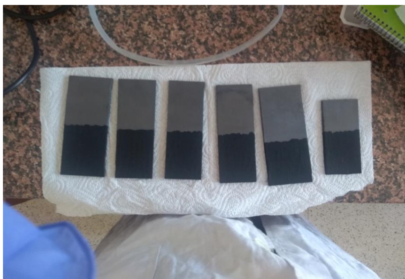
Slika 25 . Elektrode s slojem aktivnog ugljika korištene u eksperimentu. Gornji dio elektroda je čisti grafit, a donji dio je grafit premazan aktivnim ugljikom.
