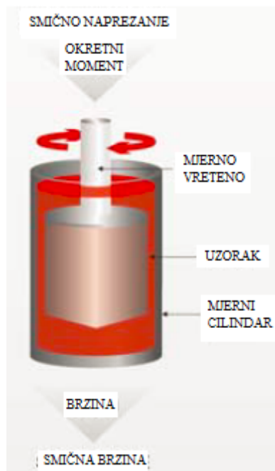
Slika 5. Princip mjerenja viskoznosti rotacijskim reometrom 3
