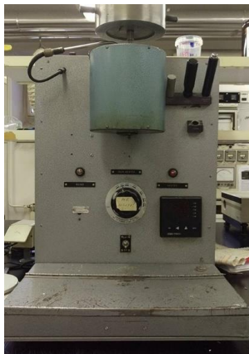
Slika 23. Uređaj za mjerenje brzine masenog protoka taljevine (MFR)
