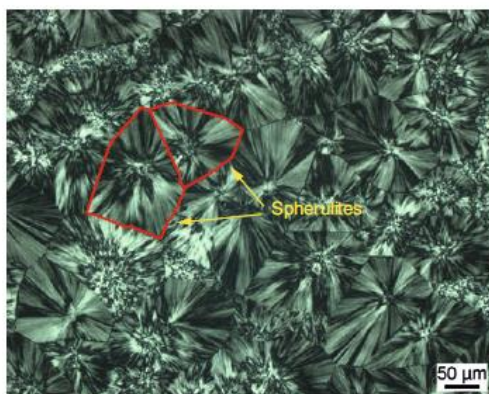
Slika 13. Sferulitne kristalične strukture u polipropilenu
