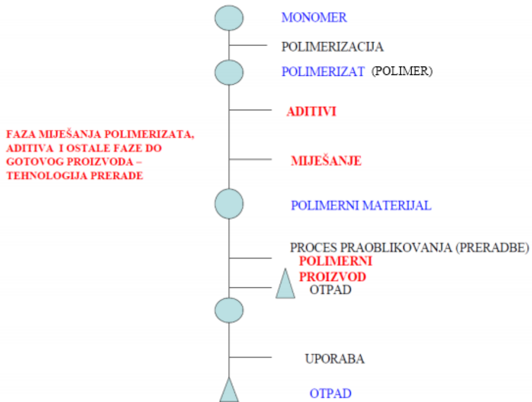
Slika 2. Faze tehnološkog procesa proizvodnje polimernih proizvoda 16
