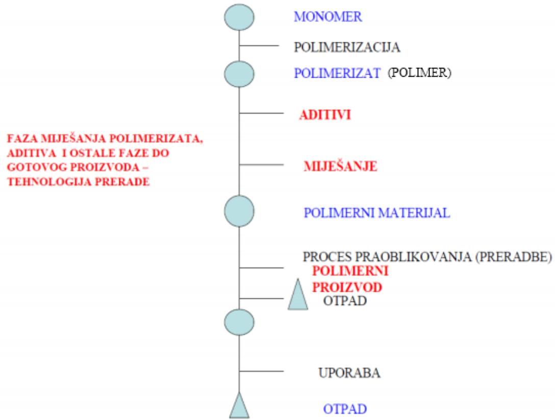
Slika 2. Faze tehnološkog procesa proizvodnje polimernih proizvoda<sup>16</sup>
