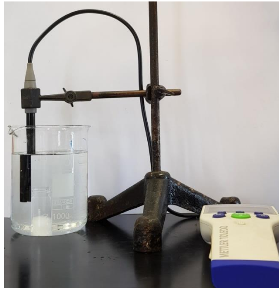
Slika 4.3 Prikaz mjerenja ionske vodljivosti prilikom ispiranja hidrogelova
