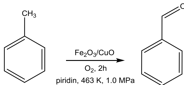
Shema 6. Dobivanje benzaldehida iz toluena
