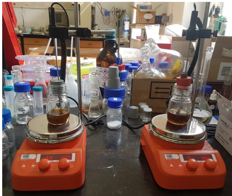
Slika 9. Laboratorijski šaržni ekstraktor s magnetskom miješalicom
