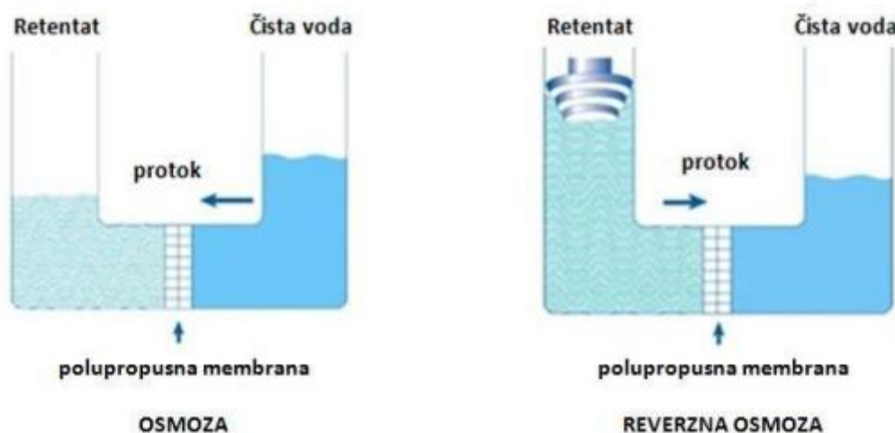
Slika 2.3. Shematski prikaz procesa osmoze i reverzne osmoze 5
