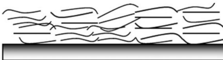
Slika 5.4. Model stvorenog algamat gela na površini membrane 43
