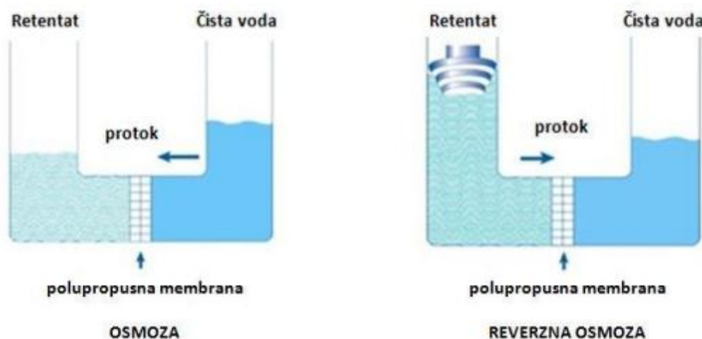
Slika 2.3. Shematski prikaz procesa osmoze i reverzne osmoze 5
