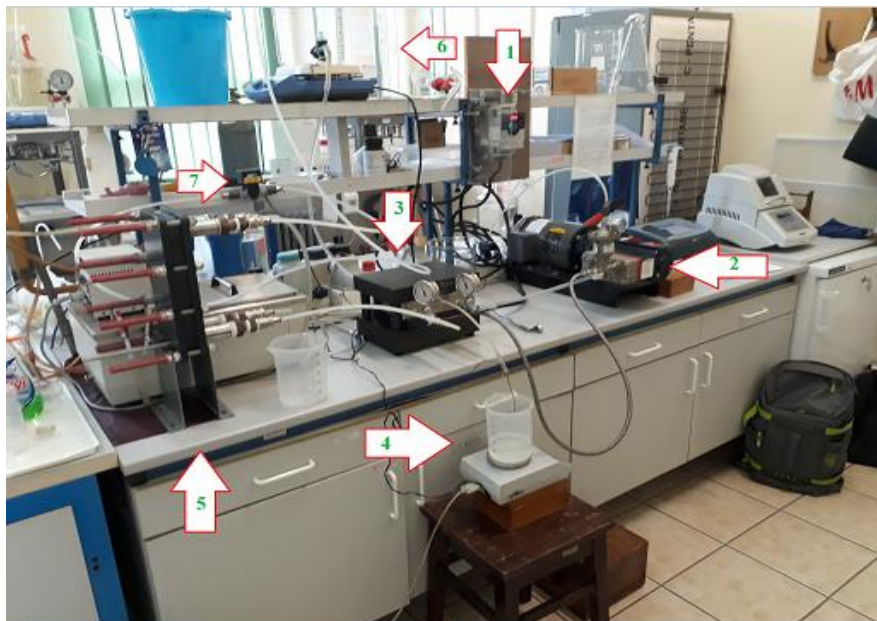
Slika 3.1. Laboratorijska RO aparatura na kojoj je proveden eksperiment (1-frekvencijski izmjenjivač, 2-pumpa, 3-okvir u kojem se nalazi membrana, 4-vaga, 5-izmjenjivač topline, 6-spremnik za otopinu, 7-mjerač protoka retentata)
