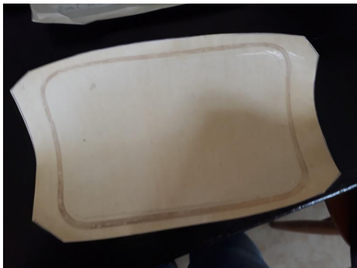
Slika 3.2 NF90 membrana korištena u eksperimentu
