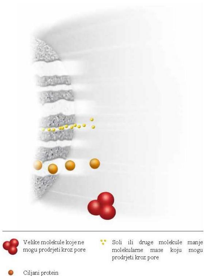
Slika 5. Pojednostavljeni prikaz razdvajanja različitih molekula kromatografijom isključenja po veličini
