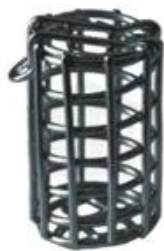
Slika 14. Košarica za potapanje tablete; fotografija i dimenzije
