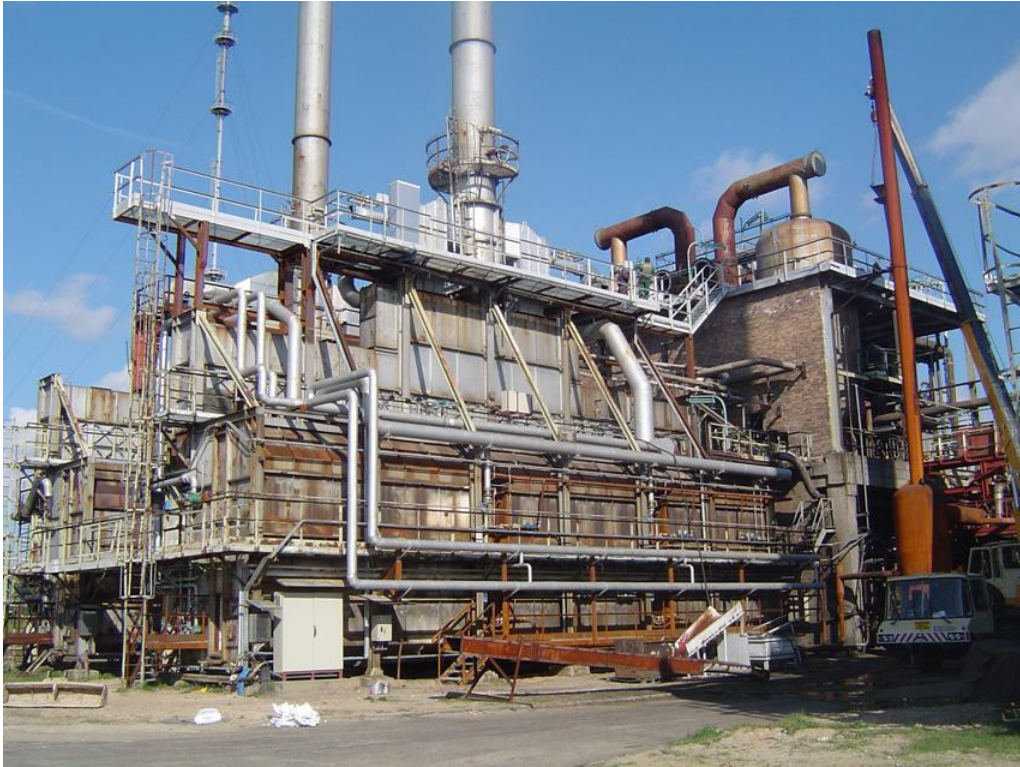
Slika 13. Industrijska peć za atmosfersku destilaciju 26
