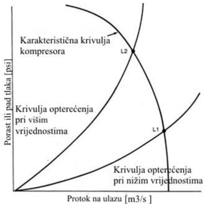
Slika 7. Karakteristična krivulja aksijalnog kompresora
