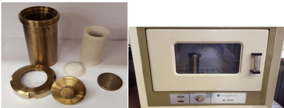
Slika 3.4. : Autoklav i sušionik korišteni kod redukcije grafenova oksida
