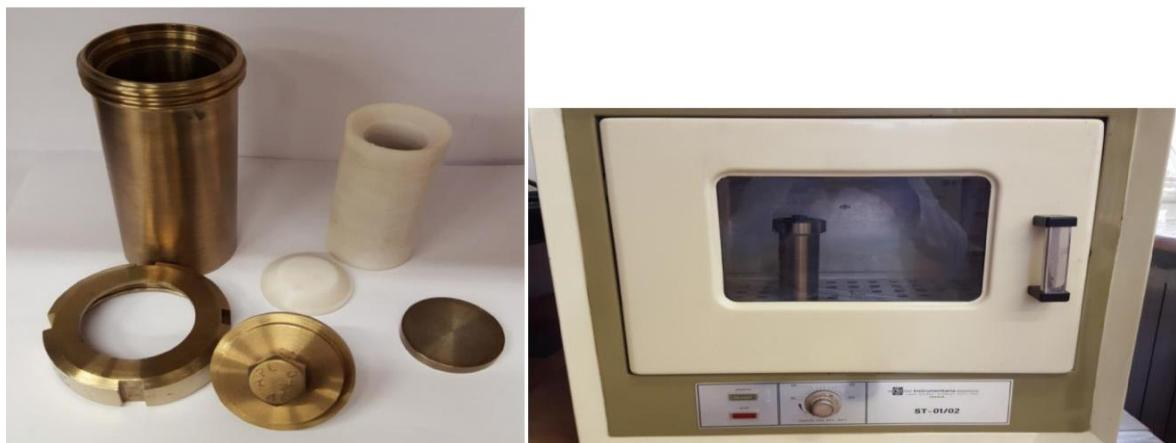
**Slika 3.4. :** Autoklav i sušionik korišteni kod redukcije grafenova oksida
