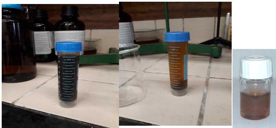
a) Otopina grafitovog oksida prije centrifugiranja b) Otopina grafitovog oksida nakon centrifugiranja c) Grafenov oksid
