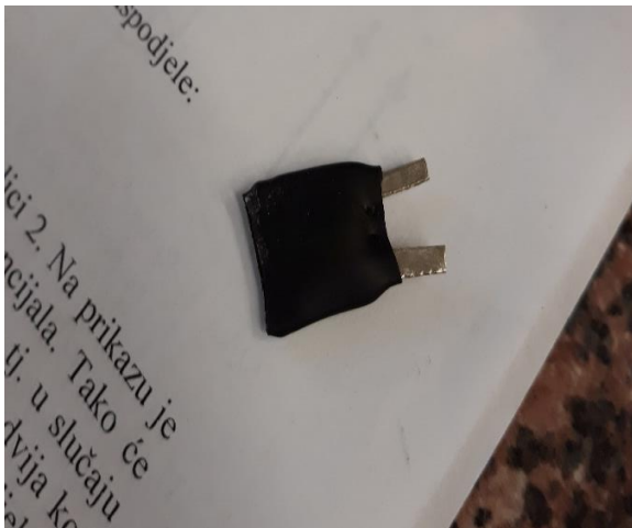
Slika 3.6. : Postupak izrade superkondenzatora :
