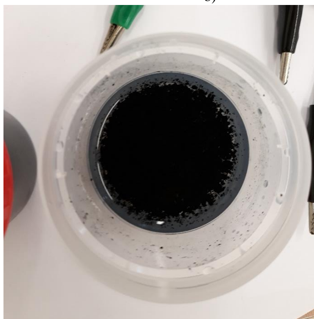
Slika 3.5. : a) Uzorak rGO dobiven hidrotermalnom sintezom bez prisustva OMW-a b) Grafenov oksid c) Uzorak rGO dobiven hidrotermalnom sintezom uz prisustvo OMW-a
