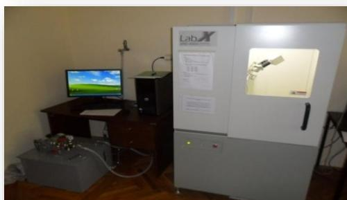
*Slika 16.* Uređaj za rendgensku difrakciju praha Shimadzu XRD
