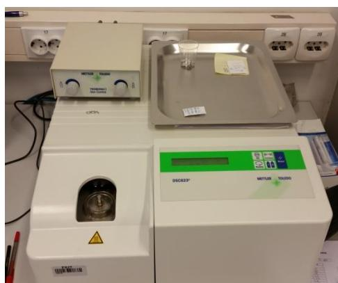
*Slika 17.* DSC uređaj MettlerToledo DSC 822<sup>e</sup>
